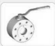
ZAWÓR KULOWY BLOKOWY WK4b WYSOKIE CIŚNIENIE Katalog str. 10,11 Ciśnienie pracy: PN 63-100, Zakres temperatur: od -30°C do +110°C
